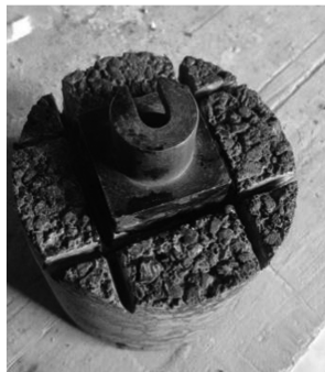
图 D-2 结构层-黏结层层间黏结试验时拉头黏结示意图及实物图
